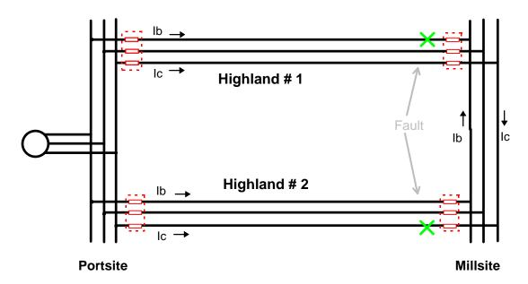
FIGURE 5: DOUBLE-CIRCUIT LINE WITH SIMULTANEOUS GROUND FAULTS
